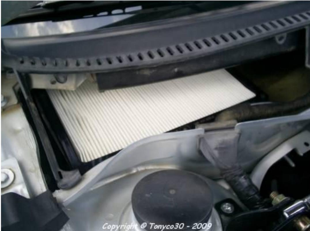
Clipper le cadre avec le support du filtre, remettez la réglette arrondie et replacer le couvercle, en faisant attention que les parties caoutchouc ne soient pas pliées (afin d'obtenir une bonne étanchéité)
