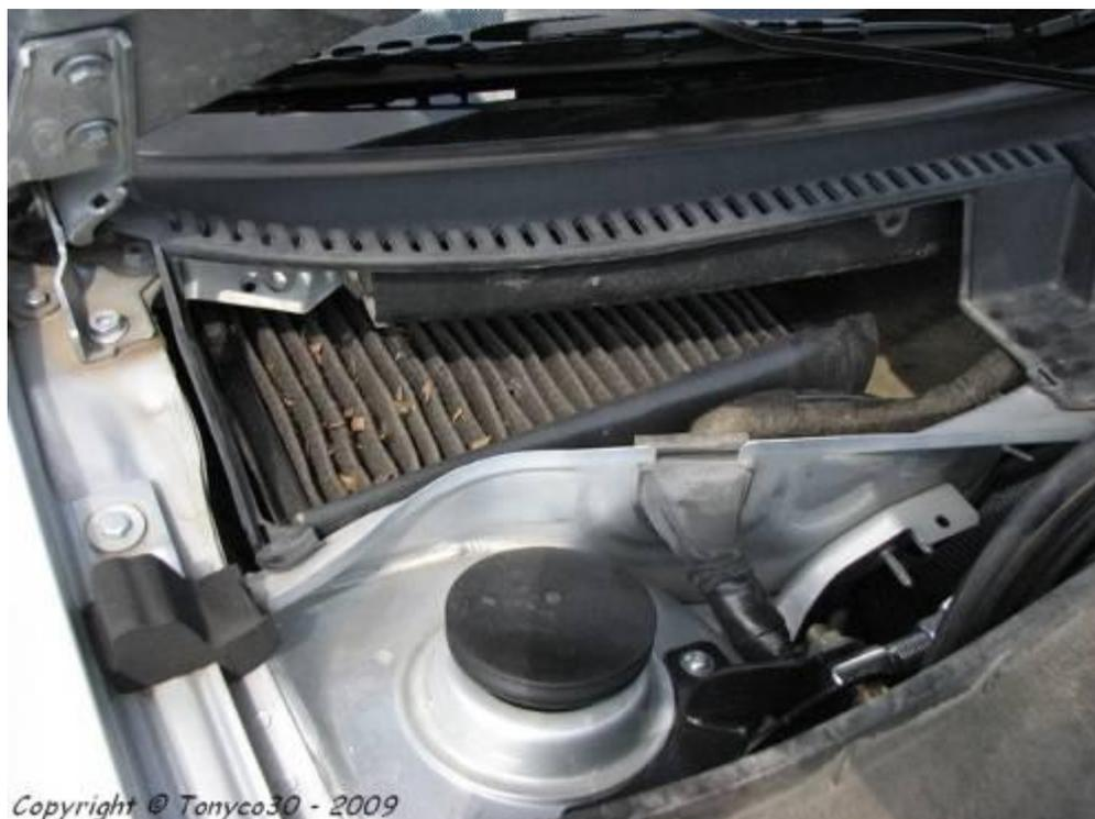
Déposer le filtre usagé, retirer le cadre en plastique et replacer ce cadre sur le filtre neuf.
